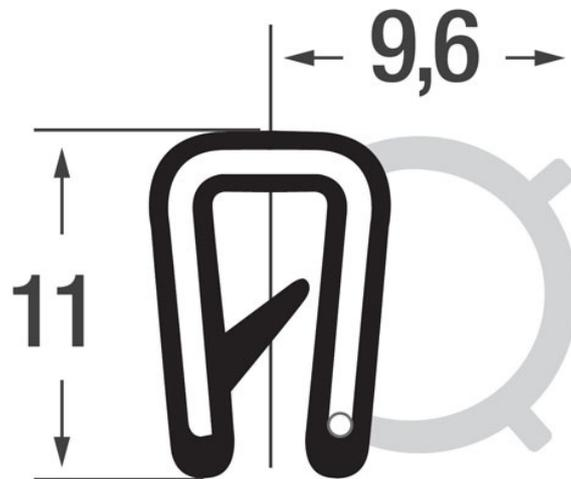
Kantenschutzklemmprofil (EPDM mit Metalleinlage) in Schwarz mit Dichtschlauch seitlich (EPDM)
